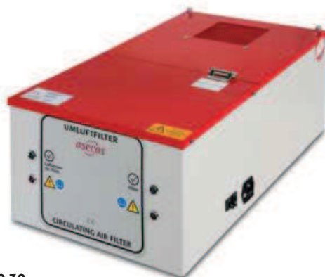
UFA.20.30 Caisson de ventilation avec filtration intégrée pour produits inflammables avec détection automatique de la saturation du filtre et contrôle du flux d'air. L x P x H (mm) : env. 305 x 555 x 210 Poids (kg) : env. 12
