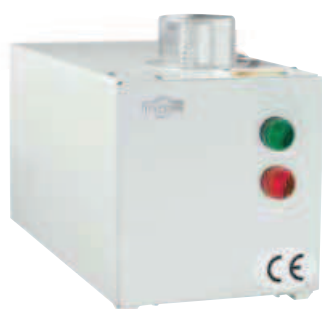
HF.EA.11442 Caisson de ventilation emboîtable insonorisés avec contrôle du flux d'air. Renouvellement 120 fois le volume d'air. Renouvellement de 120 fois le volume d'air de l'armoire. L x P x H (mm) : env. 200 x 400 x 200 Poids (kg) : env. 7
