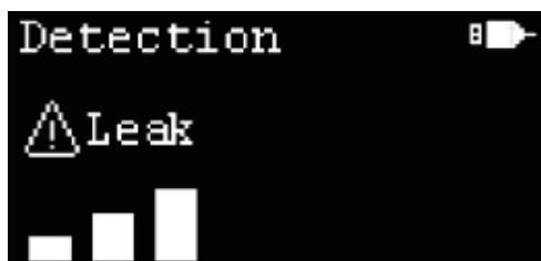
Figure 3. Exemple d'identification de fuite sur l'écran OLED.
