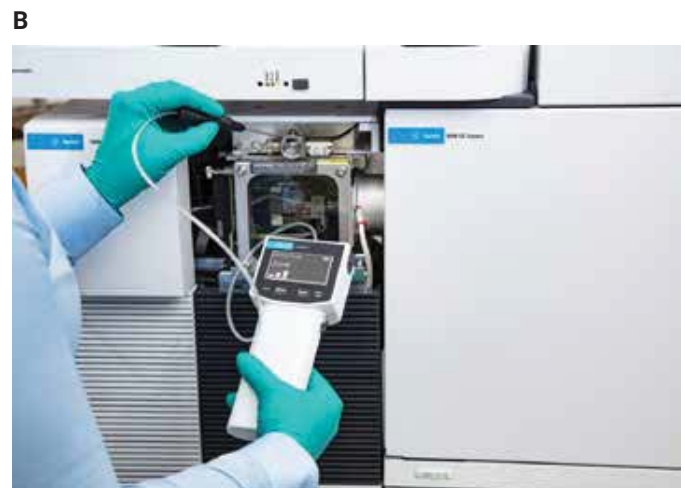
Figure 16. Vérification de l'étanchéité sur un système GC/MS au niveau de la ligne de transfert du spectromètre de masse et le four GC (A) et au niveau de la vanne de mise à l'atmosphère (B) du spectromètre de masse.
