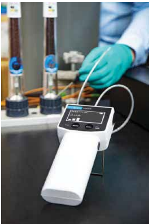
Figure 8. Exemple de contrôle d'étanchéité d'un système filtre Gas Clean avec le détecteur de fuite électronique Agilent CrossLab CS.
