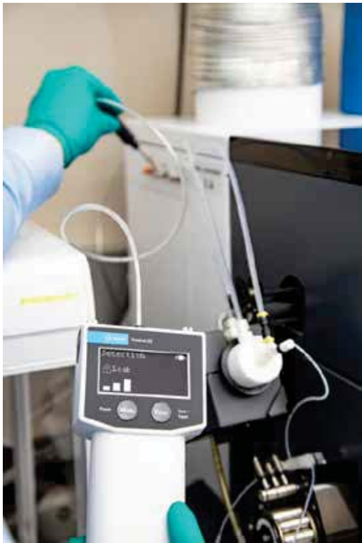
Figure 18. Utilisation d'un détecteur de fuite électronique Agilent CrossLab CS pour vérifier l'étanchéité des ports de gaz optionnels sur l'ICPMS Agilent 7900.
