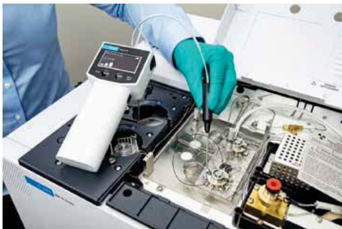
Figure 6. Exemple de contrôle d'étanchéité d'un système de vannes avec le détecteur de fuite électronique Agilent CrossLab CS.
