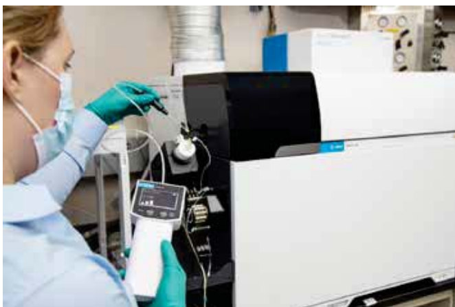
Figure 19. Vérification de l'étanchéité des raccords du nébuliseur sur l'ICPMS Agilent 7900.
