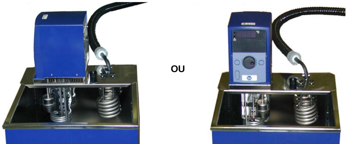
Schéma 9 : montage du thermoplongeur sur le pont
