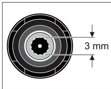
Contrôler le remplissage: examiner la surface frontale. Aucune bulle d'air ne doit être visible à l'intérieur du cercle marqué par des tirets. Les bulles d'air se trouvant à l'extérieur de cette zone sont sans importance.
