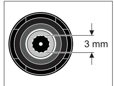
Contrôler le remplissage: examiner la surface frontale. Aucune bulle d'air ne doit être visible à l'intérieur du cercle marqué par des tirets. Les bulles d'air se trouvant à l'extérieur de cette zone sont sans importance.
