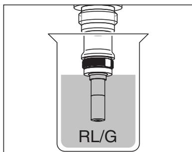
Immerger la tête de sonde, contre-électrode comprise, dans la solution de nettoyage RL/G.
