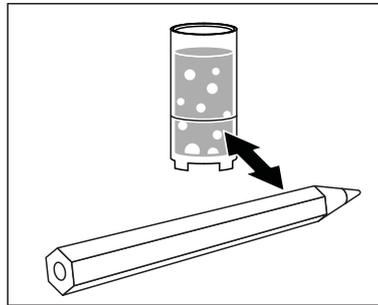
Éliminer les bulles d'air éventuelles par de légers frappements. Il est également possible d'empêcher la formation de bulles d'air en jetant le premier remplissage et en remplissant à nouveau.
