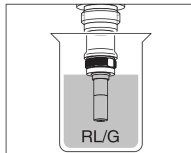
Immerger la tête de sonde, contre-électrode comprise, dans la solution de nettoyage RL/G.
