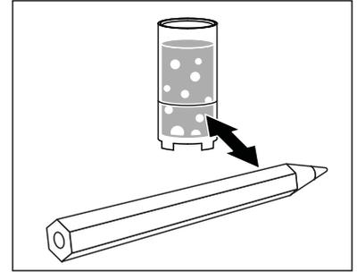
Éliminer les bulles d'air éventuelles par de légers frappalements. Il est également possible d'empêcher la formation de bulles d'air en jetant le premier remplissage et en remplissant à nouveau.
