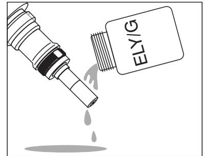
Rincer la tête de sonde avec de la solution d'électrolyte.
