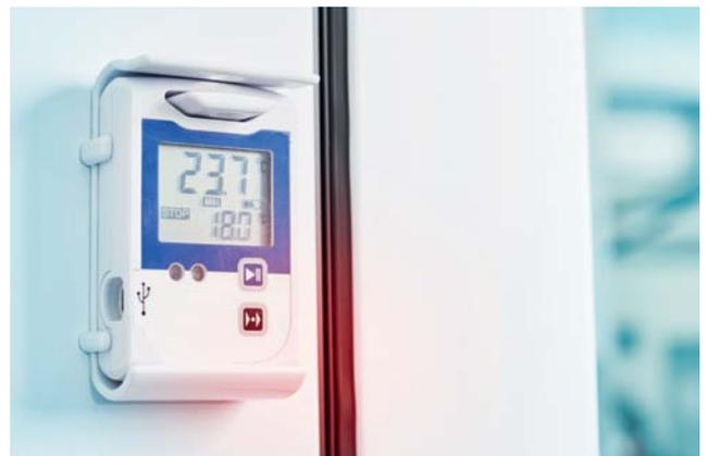
Il est possible de fixer l'enregistreur de données de façon magnétique sur les congélateurs Versafreeze et de le configurer et le lire par le biais d'un port USB
