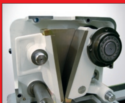
Vue de l'enceinte de broyage avec le boîtier enlevé
