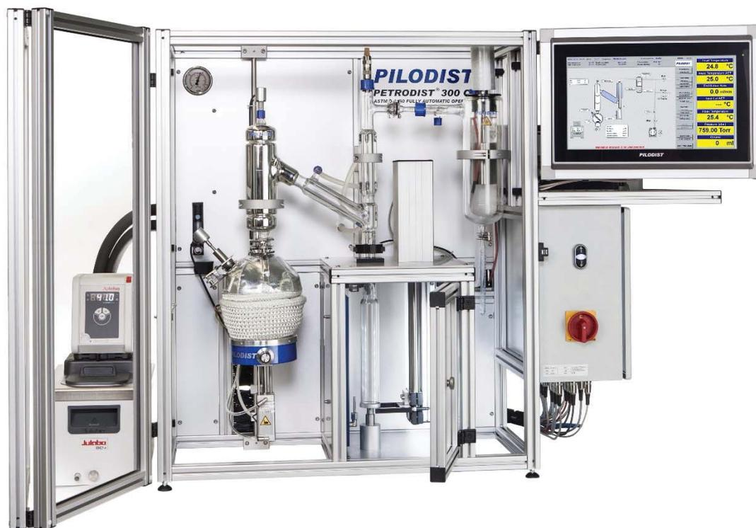
La photo représente la nouvelle version 2017 du PETRODIST 300 CC avec le contrôleur PILODIST à écran tactile (15,6") IP65, remplaçant les PC et les ordinateurs portables dans notre nouvelle série. Le contrôleur peut être installé à distance ou dans le cadre du système. Façade entièrement vitrée, IP 65, utilisable avec des gants de laboratoire.
