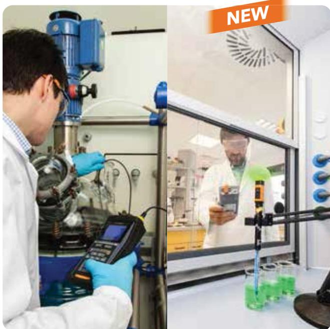
Les appareils portables MultiLine® IDS sont robustes et étanches selon IP 67. Selon le modèle, ils sont dotés d'un ou de deux ports USB et d'écrans couleur.
