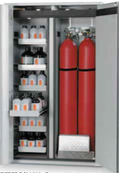
VBFT.TRG/00016+C Partie VBF "inflammable" avec 6 tiroirs et 1 système de maintien de porte intégré. Partie TRG "bouteilles de gaz" avec 1 rampe d'accès, 1 rampe de montage pour armatures et 2 sangles de sécurité. L x P x H (mm) : env. 1200 x 615 x 1968 · Poids (kg) : env. 420
