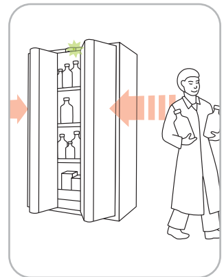
La personne quitte le champ de détection du capteur - les portes se ferment automatiquement après env. 30 secondes
