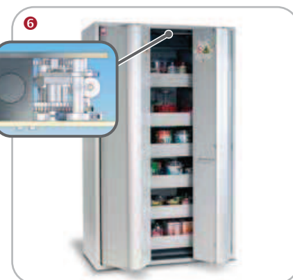
Après env. 60 secondes, les portes sont débloquées par la temporisation électromagnétique de fermeture automatique des portes (TSA) et se ferment toutes seules - sans courant
