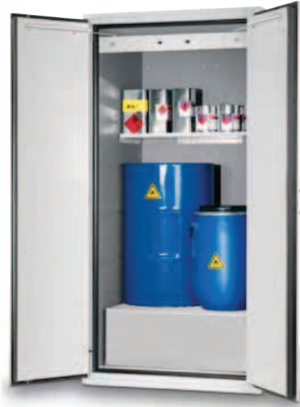
VBF.221.108-F avec 1 étagère, 1 caillebotis, 1 bac de rétention et 2 ferme portes hydraulique. Stockage d'1 fût de 200 l et de petits récipients. L x P x H (mm) : env. 1105 x 1015 x 2225 Poids (kg) : env. 850
