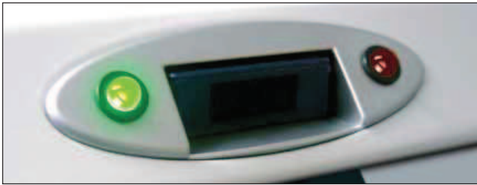
LED verte allumée : l'armoire est sous tension
