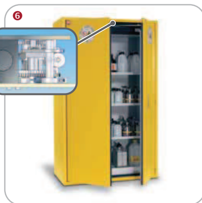
Après 1 à 2,5 minutes, les portes sont débloquées par la temporisation électromagnétique de fermeture automatique des portes (TSA) et se ferment toutes seules - sans courant
