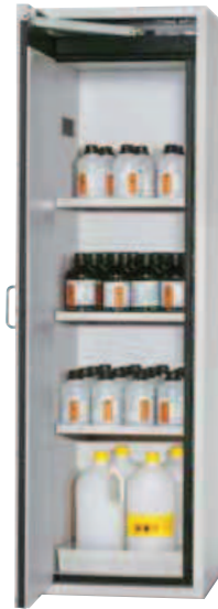
F60.196.60/31110 avec 3 étagères, 1 bac de rétention, 1 caillebotis et 1 système de maintien de porte. L x P x H (mm) : env. 600 x 615 x 1968 Poids (kg) : env. 260
