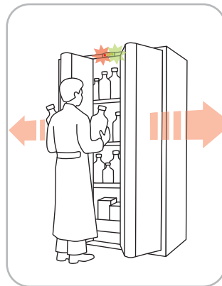
Après avoir détecté la personne, es portes pliables s'ouvrent automatiquement dans un délai d'env. 5 secondes
