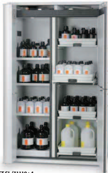
VBFT.SL/31110+4 Partie VBF "inflammable" avec 3 étagères, 1 bac, 1 caillebotis et 1 système de maintien de porte intégré. Partie SL "acides et bases" avec 4 étagères coulissantes et bacs amovibles. L x P x H (mm) : env. 1200 x 615 x 1968 · Poids (kg) : env. 420
