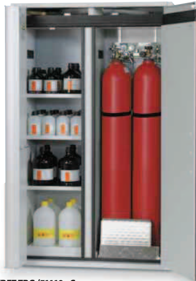
VBFT.TRG/31110+C Partie VBF "inflammable" avec 3 étagères, 1 bac, 1 caillebotis et 1 système de maintien de porte intégré. Partie TRG "bouteilles de gaz" avec 1 rampe d'accès, 1 rampe de montage pour armatures et 2 sangles de sécurité. L x P x H (mm) : env. 1200 x 615 x 1968 · Poids (kg) : env. 420
