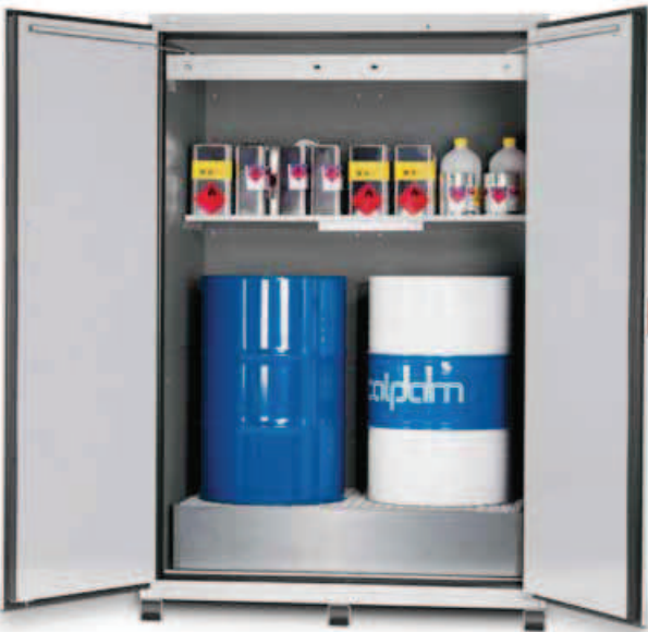
VBF.221.153-F/P avec 1 étagère, 1 caillebotis, 1 bac de rétention, 2 ferme portes hydraulique et 1 jeu de pieds. Stockage de 2 fûts de 200 l et de petits récipients. L x P x H (mm) : env. 1555 x 1015 x 2225 Poids (kg) : env. 1100
