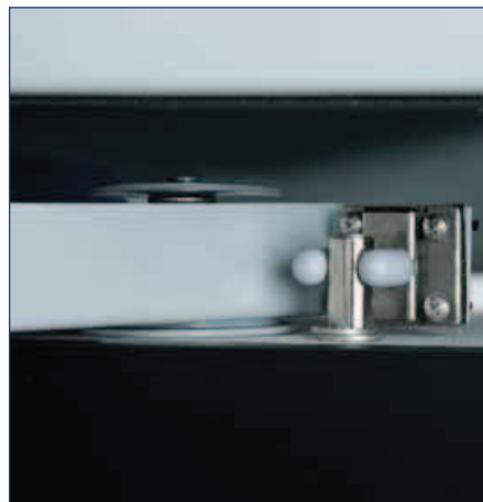
Système de maintien de porte Meilleur confort d'utilisation de l'armoire grâce aux portes ouvertes. Sécurité garantie en cas d'incendie grâce à la fermeture automatique des portes par déclenchement des thermo-fusibles intégrés à max. 50 °C
