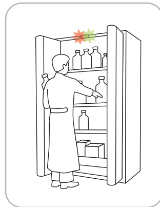
Le capteur reconnaît la personne et garde les portes ouvertes
