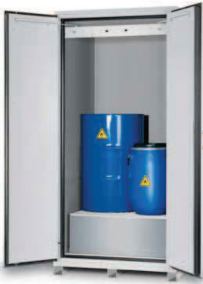
VBF.221.108/P avec 1 caillebotis, 1 bac de rétention, 2 ferme portes hydraulique et 1 jeu de pieds pour le stockage d'1 fût de 200 l et de petits récipients. L x P x H (mm) : env. 1105 x 1015 x 2225 Poids (kg) : env. 850
