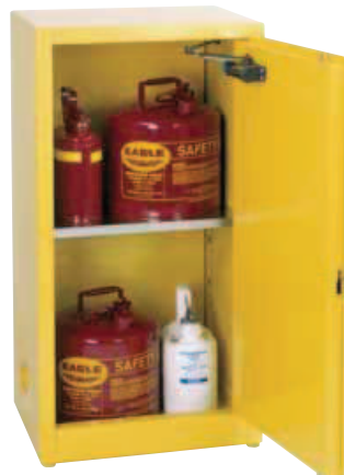
L.11857 (FM 16) avec 1 étagère, 1 bac de rétention intégré et 1 système de maintien de porte. L x P x H (mm) : env. 580 x 460 x 1120 Poids (kg) : env. 60
