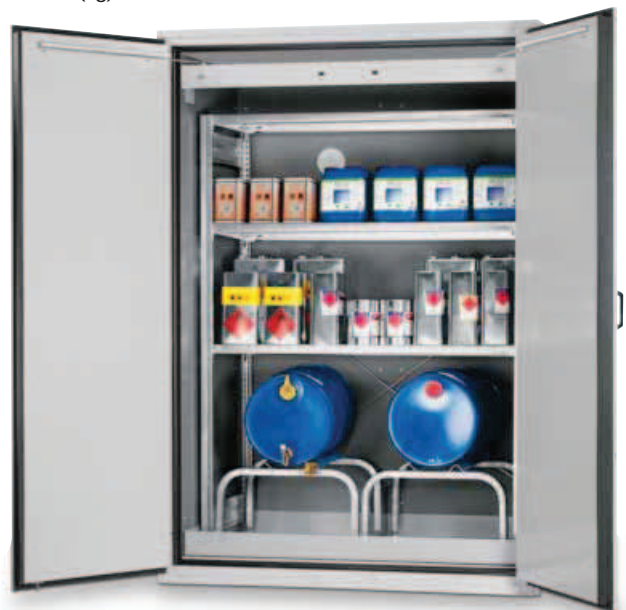
VBF.221.153-FR2 avec 1 rayonnage, 1 bac de rétention, 2 supports fûts et 2 ferme portes hydraulique. Stockage de 2 fûts de 60 l et de petits récipients. L x P x H (mm) : env. 1555 x 1015 x 2225 Poids (kg) : env. 1100
