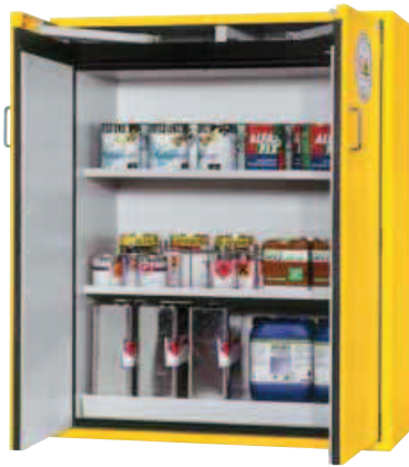
VBF.129.120-G/21110 avec 2 étagères, 1 bac de rétention, 1 caillebotis et 1 système de maintien de porte. L x P x H (mm) : env. 1200 x 615 x 1298 Poids (kg) : env. 270
