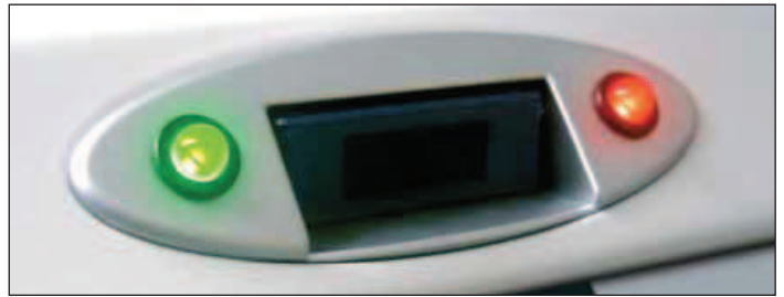
LED rouge allumée : le capteur a détecté la personne
