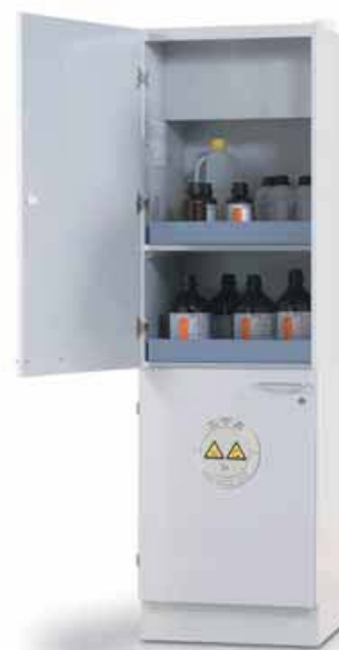
SLK.197.60 armoire en PE avec 4 étagères et bacs de rétention amovibles en PE. L x P x H (mm) : env. 600 x 600 x 1970 Poids (kg) : env. 111
