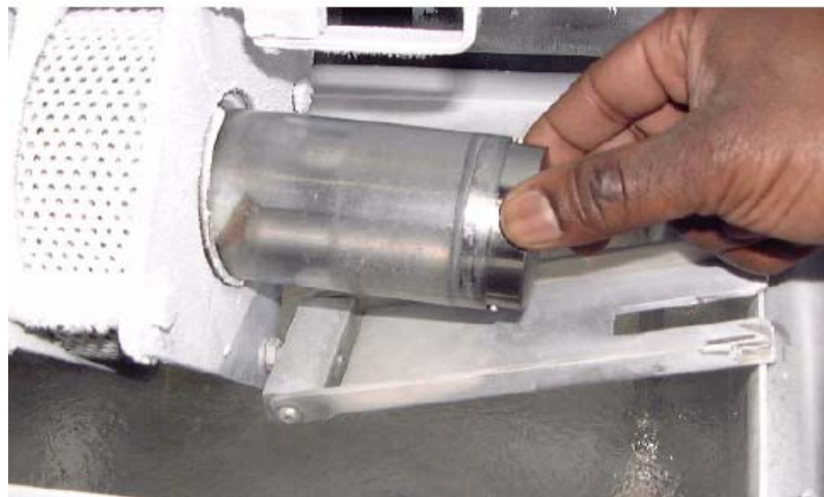
Chargement du cylindre dans le broyeur à azote liquide
